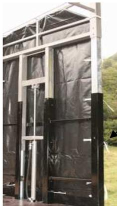
Vérin hydraulique relevage toiture
