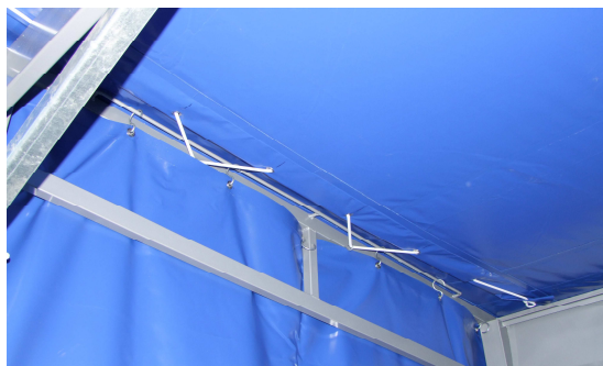
Fixation bâche toit sur le pourtour de la
