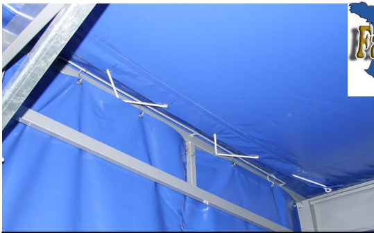
Fixation bâche toit
