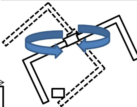
**Plan d'implantation :** Prévoir : Plot béton de 0,50x0,50x0,50 dosé à 350 kg pour le poteau de la barriere -Plot de 0,40 x 0,40 x 0,50 m pour le poteau seul -1300 mm d'axe à axe
